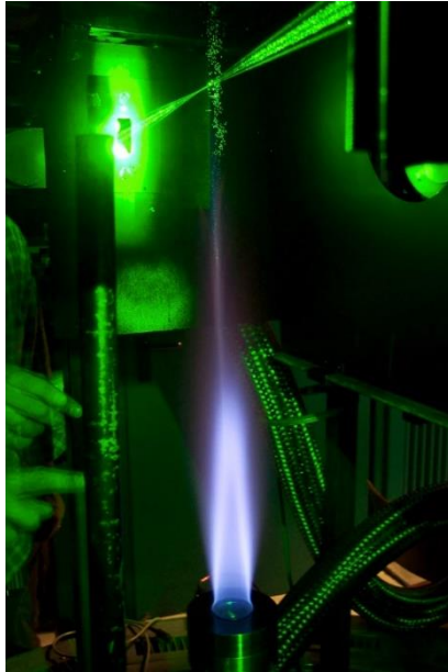
Laser-Diagnostik an einer Erdgasflamme, Quelle: ITT
