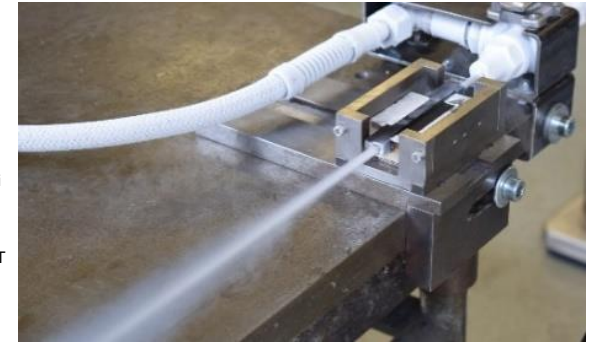
Kühlung mit flüssigem Stickstoff bei der Zerspänung von Titan P. Golda, ITT
