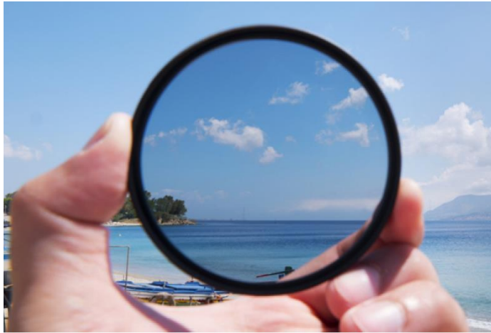
Effekt eines Polarisationsfilters Quelle: IPQ-Foliensatz: EMW_WS1920_191118.pdf Elektromagnetische Wellen Wintersemester 19/20
